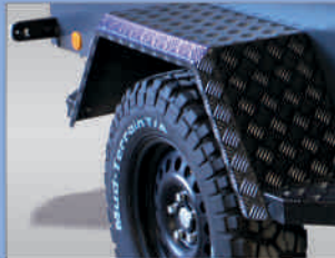
Offroad-Version: begehbare Kotflügel mit Trittleiste
